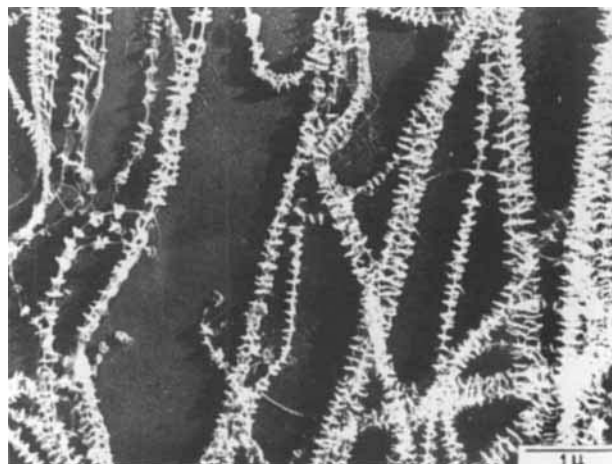
Abb. 4. Elektronenmikroskopische Aufnahme von durch scherinduzierte Kristallisation erhaltenen PE-Kristallen [31].
